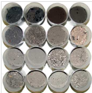
Slika 15; Pepel svetlejše in sive barve ima manj ostankov lesa in je posledica boljšega zgorevanja (Vir: www.bioregio.info )
